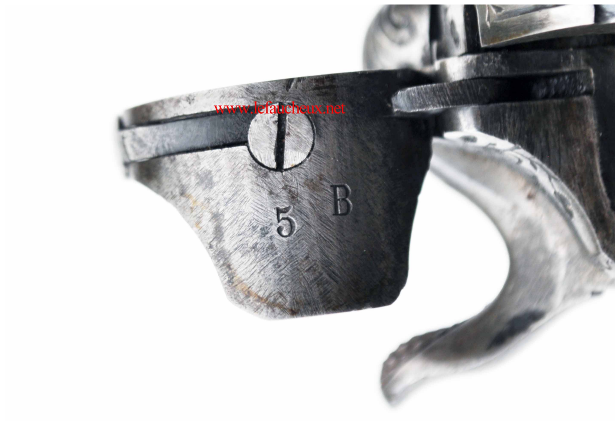
Le numéro d'assemblage, qu'on retrouve sur l'ensemble des pièces est le « 5 B »
